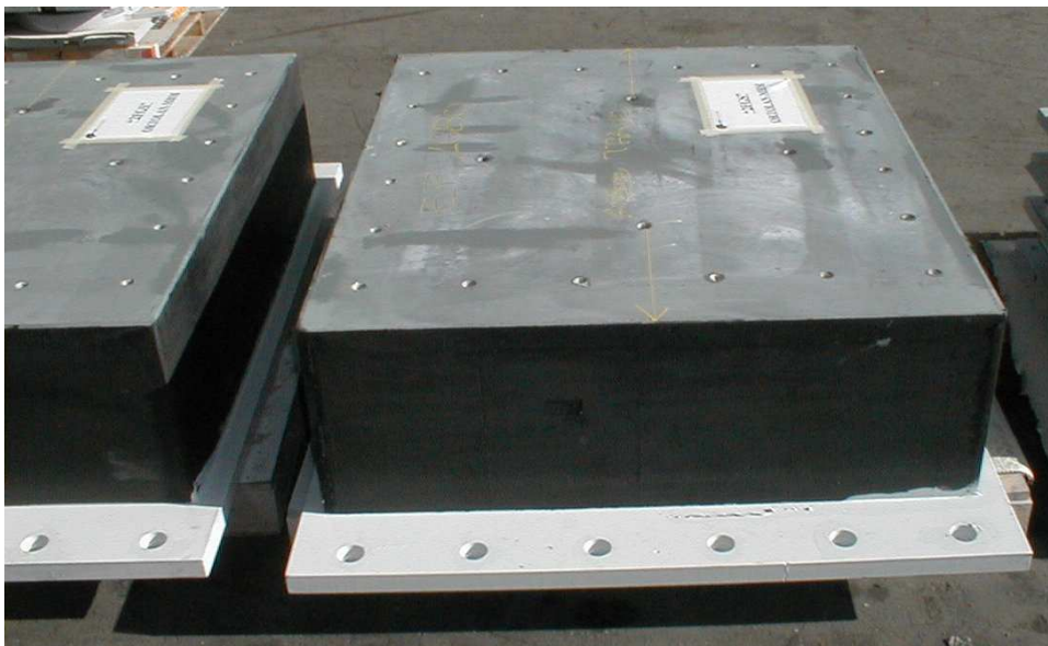
Figura 5: Apparecchi d'appoggio smorzanti per le pile centrali
